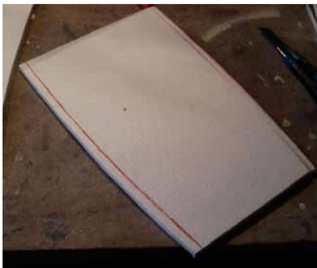
Sl. 6. dvije stranice treba suziti za debljinu ploče
